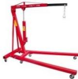
PLUMA HIDRÁULICA DE 2 TONS
